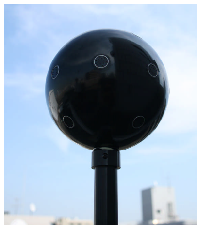
球パツフルマイクロホン(SBM)センサー
