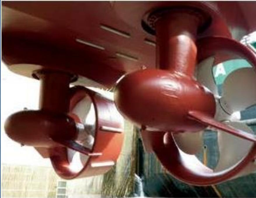
全旋回式縦軸型推進器
